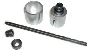
Die Drucktöpfe haben einen Sichtschlitz, so dass der Pressvorgang zu jeder Zeit kontrolliert werden kann.
