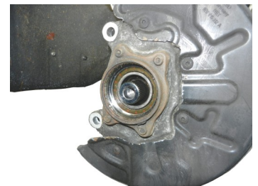
Die Antriebswelle kann jetzt aus dem Achsschenkel ausgeschwenkt werden.
