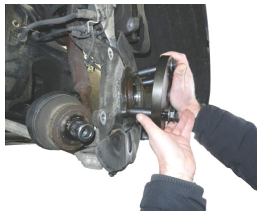
Den Kompaktlagerauszieher K 301-62 mit den Abstandshülsen und den Schrauben an das Radlager anflanschen.
