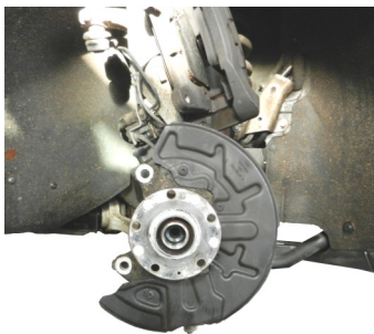
Achsmutter lösen, Bremsattel und Bremsscheibe demontieren.
