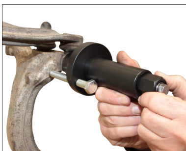
Abzugshülse mit Abstützvorrichtung ansetzen...
