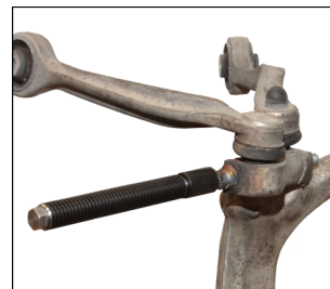
schlagschrauberfeste Abzugsspindel aufschrauben...
