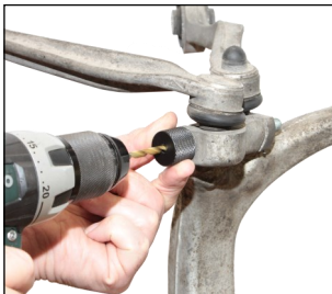
mit der Zentrierhilfe anbohren..
