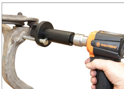
mit dem Schlagschrauber die Schraube ausziehen...
