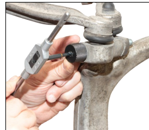
mit Gewindevorschneider ein Gewinde M6 einbringen...
