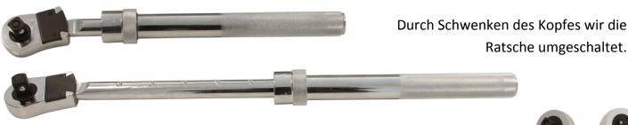
**K 251** Art.-Nr. 112166, 1/4" Teleskop-Knick-Umschalt-Ratsche 150-200mm **K 252** Art.-Nr. 112167, 3/8" Teleskop-Knick-Umschalt-Ratsche 240-350mm **K 253** Art.-Nr. 112168, 1/2" Teleskop-Knick-Umschalt-Ratsche 300-450mm Durch Umknicken des Ratschenkopfes wird die Drehrichtung umgeschaltet. Alle Ratschen haben eine 72er Verzahnung.
