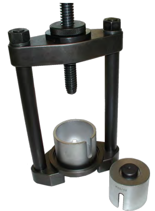
...zur Verwendung im Pressrahmen mit K 65-300 Einlegeplatte und Druckstück.
