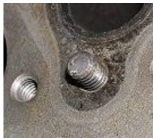
...bis auf den Zylinderkopf plan schleifen...
