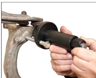
Abzugshülse mit Abstützvorrichtung ansetzen...
