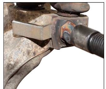
Stützwinkel in die Schlitz einsetzen...
