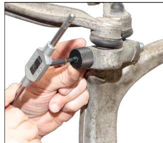
mit Gewindezentrierhilfe ein Gewinde M6 einbringen...
