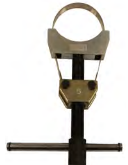
K 65-402 Uni-Vorspann-Werkzeug von 56-70 mm Art.-Nr. 111303
