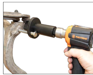
mit dem Schlagschrauber die Schraube ausziehen...
