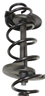
Entspannte Feder mit angesetztem Federspanner.
