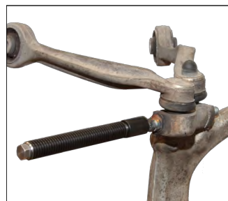
schlagschrauberfeste Abzugsspindel aufschrauben...
