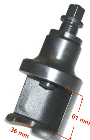
K 431-6 MB Sprinter / Crafter SW 27 Art.-Nr. 112036 1-teilig, Gewicht 3,4kg speziell geformt, passt sich genau dem Achsschenkel an
