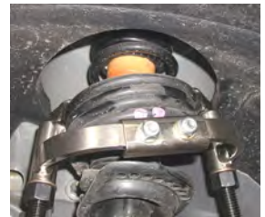
Feder komplett gespannt unter dem Kotflügel
