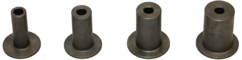
Die Hülsen sind leicht konisch, so dass sie sich im anzuschraubenden Bauteil mittig zentrieren (z.B. bei M8 von 8,5 bis 8,85mm)
