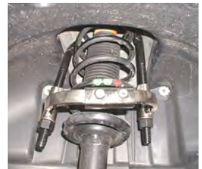
Federspanner unter dem Kotflügel angesetzt
