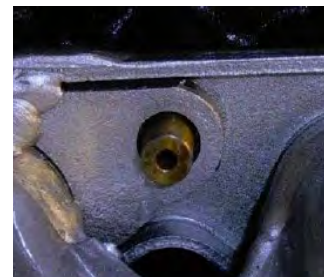
...Krümmer mit restlichen Schrauben befestigen bis die Ausbohr-Zentrierhülse plan aufliegt. Anschließend mit 4mm Bohrer Zentrumsbohrung herstellen.
