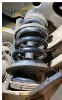
Beispiel: gespannte Feder beim Audi A6 C8 4K
