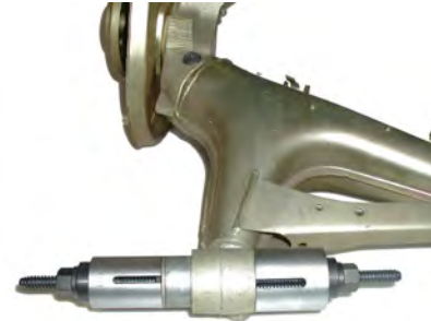
z.B. zum Ein- und Auspressen von Silentlagern ...
